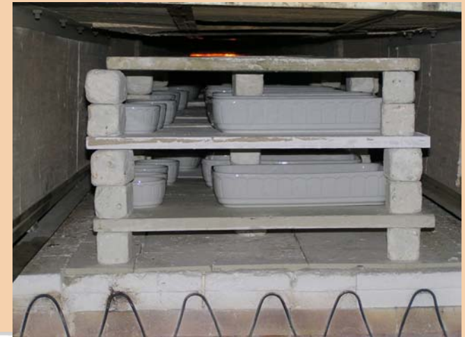
Aufbau gebrannte Ware auf herkömm- lichen Brennplatten mit Blick in Schnellbrandofen
