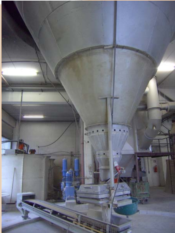
Austrag eines Sprühtrockners zur Granulatherstellung
