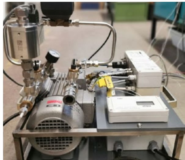
Das automatisch geregelte Staubkonzentrationsmesssystem begleitet die Betriebsmessungen.
